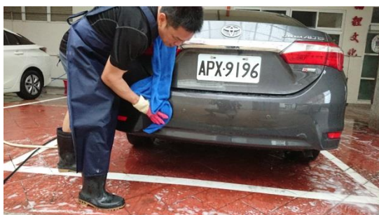
▲ 施作時留意擦車布不可拖地，以免夾帶地上的髒污刮傷保險桿
