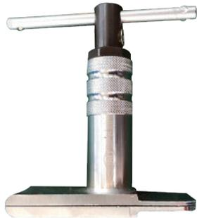
▲圖 5-3 煞車卡鉗活塞調整器。
