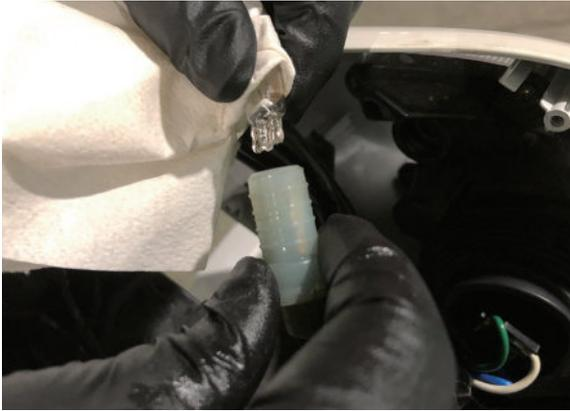
12 使用三用電錶測量小燈燈泡之電阻值，其正確電阻值必須扣除三用電錶內阻。
