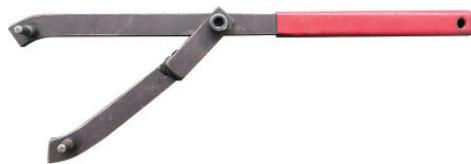
▲ 圖 9-7 萬用型固定扳手（Y 型固定扳手）
