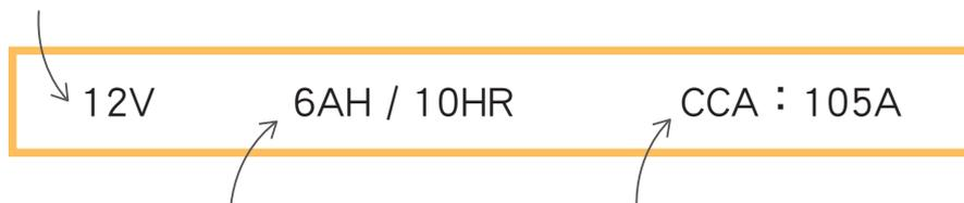
表示電瓶容量。容量 = 放電電流 (A) × 到達放電終止電壓的時間，6 Ampere Hour / 10 Hour，即表示電瓶以 0.6 安培放電，放電 10 小時（機車電瓶一般採 10 小時率），其電壓降至 10.5 伏特（放電終止電壓）。故 6AH = 0.6 A × 10 H，在條件一致的情況下，允許的放電電流越大，電瓶的容量越大。
