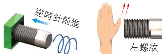
3. 部分廠家之照後鏡左右兩邊分別為正反螺紋，拆裝反螺紋之照後鏡時，要特別注意旋轉方向避免損壞螺紋。
