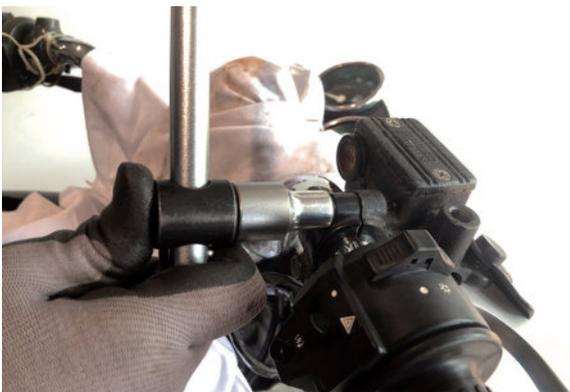
4 取下油管螺栓、密封墊片、煞車總泵及煞車總泵固定座。
