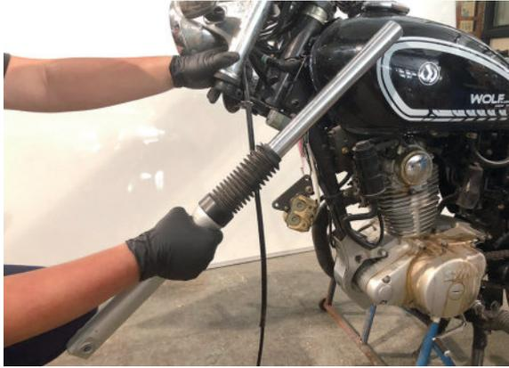
12 用手推入及拉出避震器活塞桿，檢查是否有不正常阻力或異音，若避震器作用不良則更換新品。
