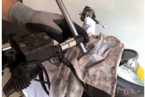
3 拆卸煞車總泵固定座螺栓。
