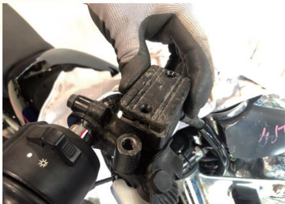
12 拉動煞車拉桿數次，測試煞車功能是否正常，檢查系統是否漏油。
