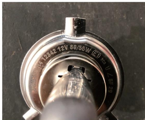
▲圖 4-2 燈泡規格： 12V 60/55W
