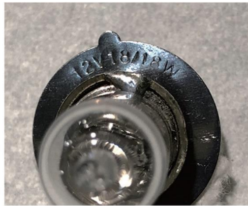
▲圖 4-3 燈泡規格： 12V 18/18W
