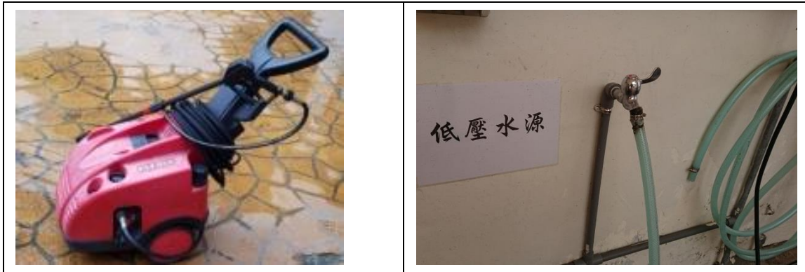
▲ 高壓機產生高壓水
