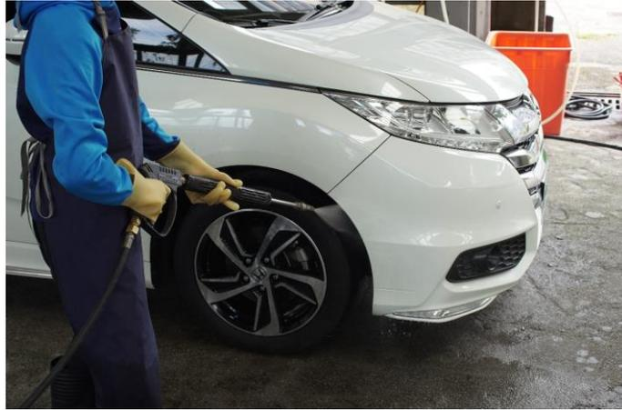
▲ 使用高壓清洗機以扇形方式清洗輪弧
