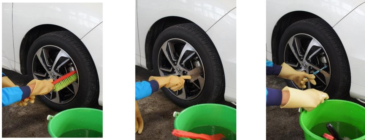
▲ 使用各類清潔工具將輪框清潔乾淨(鋼圈刷、螺旋鋼圈刷、牙刷)
