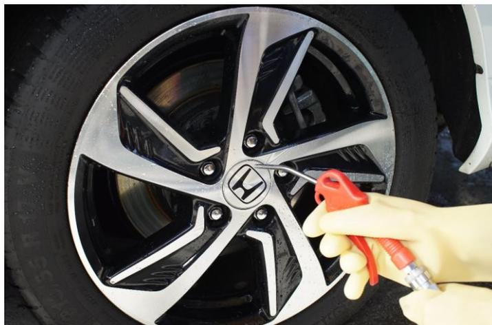
▲ 使用空壓機將輪框的水噴出並擦乾
