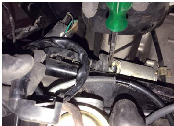
5 拆卸起動馬達固定螺栓，取下起動馬達。
