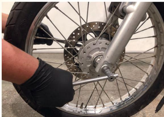
6 取下固定螺帽、輪軸、速度錶齒輪組、軸套及前輪。
