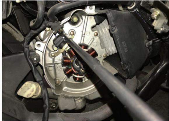
7 拆卸發電機導線固定片與發電機的固定螺栓。
