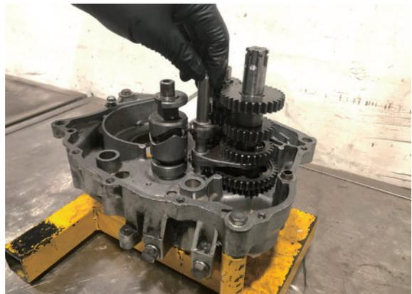
3 拆卸變速凸輪及變速筒總成。
