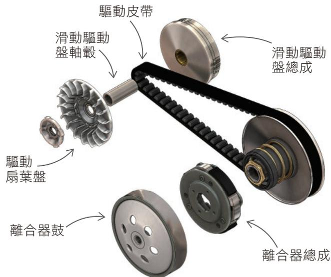
圖 9-1 驅動皮帶式無段自動變速系統圖
