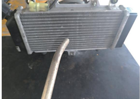
13 檢查拆卸的水管是否有龜裂，管夾是否有損壞。
