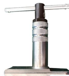
▲圖 6-5 煞車卡鉗活塞調整器
