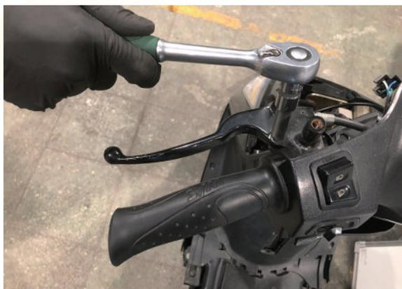
6 分離煞車拉桿與煞車鋼索。
