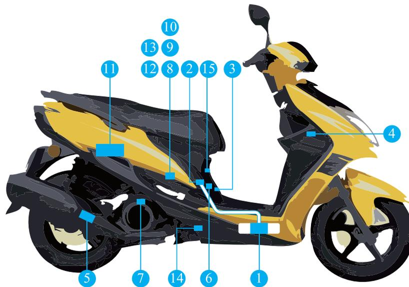
▲ 圖 8-1 汽油噴射系統位置圖
