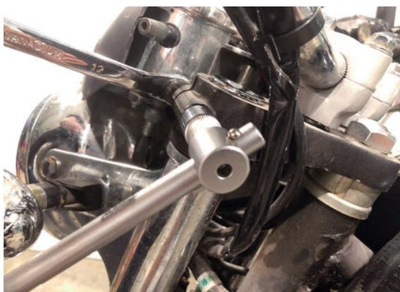
9 拆卸前輪擋泥板。
