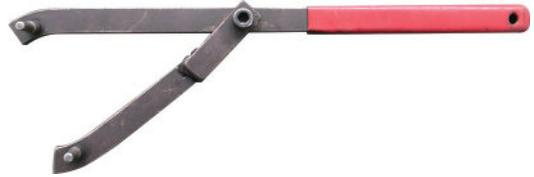
▲ 圖 7-4 萬用型固定扳手 (Y型固定扳手)
