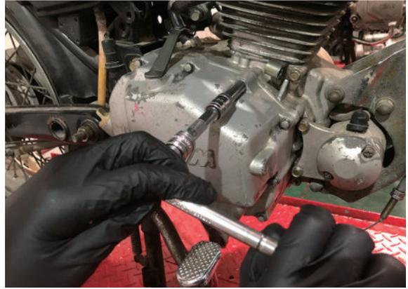
7 取下離合器頂桿、離合器頂桿導銷及軸承。
