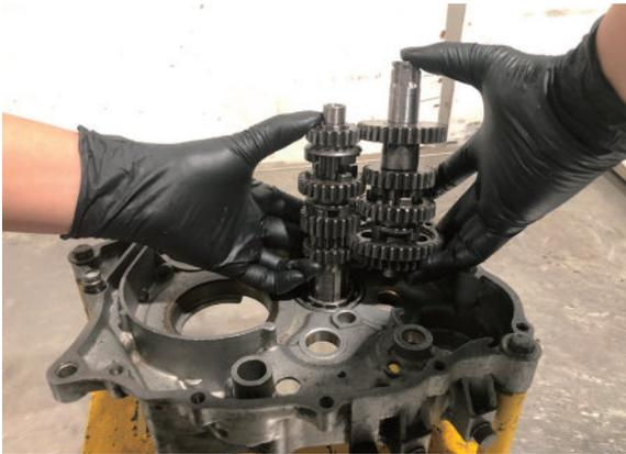
8 逐一分解變速主軸及副軸上齒輪及間隙片，並依序排列放置。
