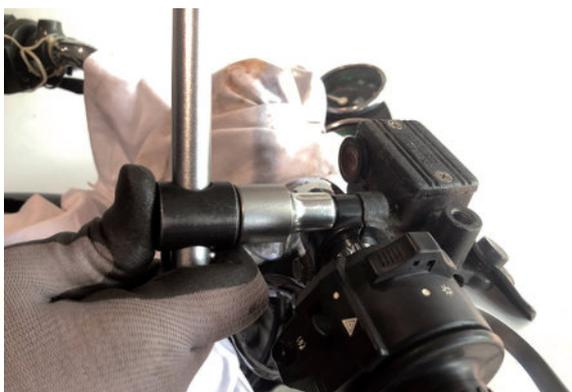
4 取下油管螺栓、密封墊片、煞車總泵及煞車總泵固定座。
