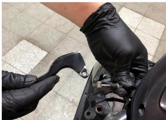
7 取下煞車鋼索、煞車調整螺帽固定銷及煞車調整螺帽。
