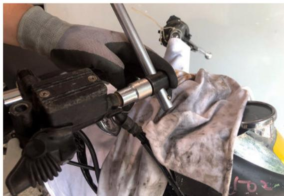
3 拆卸煞車總泵固定座螺栓。
