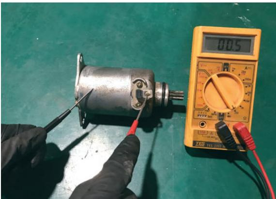
2 動態測試：測量起動馬達無負荷作動電流值，實測電流值： $17.64\text{A}$ 。
