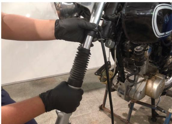
2 用手固定避震器活塞桿，鎖緊前輪避震器上方固定螺栓及螺帽。
