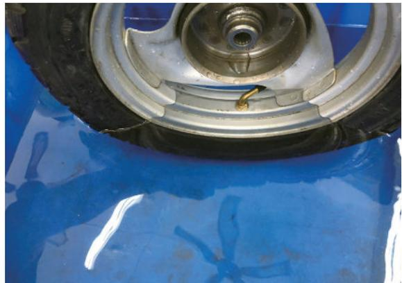
17 使用高壓空氣吹乾氣嘴，安裝氣嘴塑膠螺帽。
