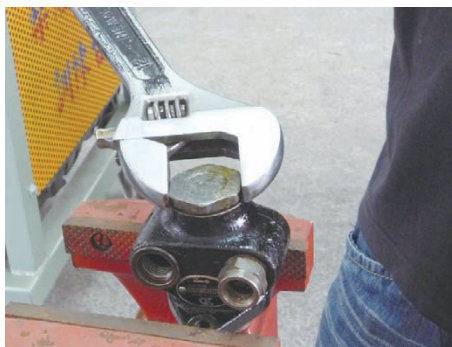
(a) 拆除旋塞
