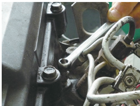
▲ 圖 7-106 拆除預熱塞接頭
