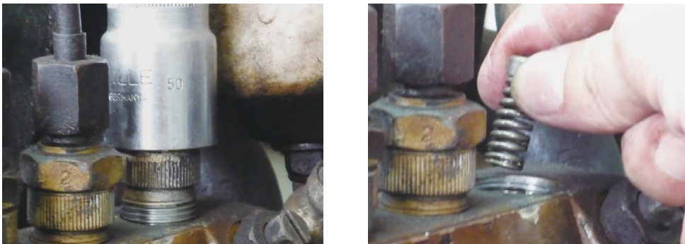
▲ 圖 5-6 拆下噴射泵第一缸輸油門套並取出輸油門彈簧
