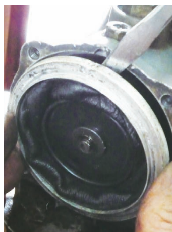
▲ 圖 7-17 拆除真空膜片
