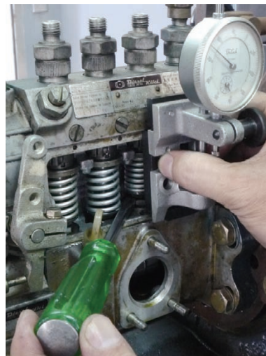
▲ 圖 6-9 檢查頂子間隙
