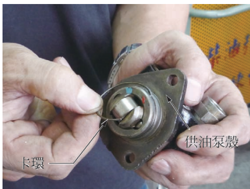
▲ 圖 7-4 拆卸固定卡環
