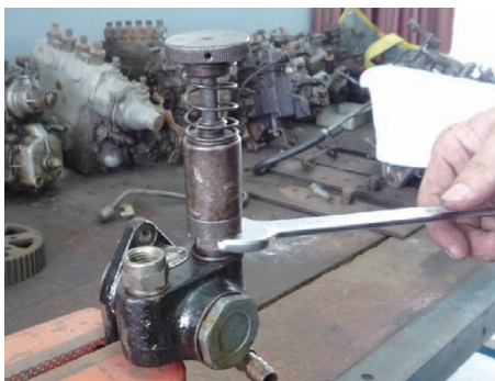
▲ 圖 7-3 拆卸手動泵
