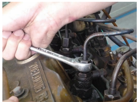
▲ 圖 4-4 放鬆高壓油管螺帽
