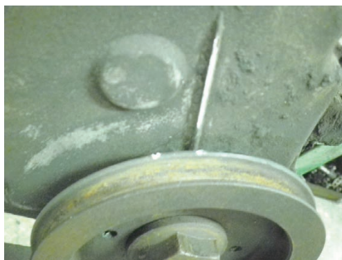
▲ 圖 5-5 將第一缸活塞轉至上死點前 20°
