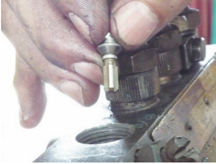
▲ 圖 7-34 拆除輸油門
