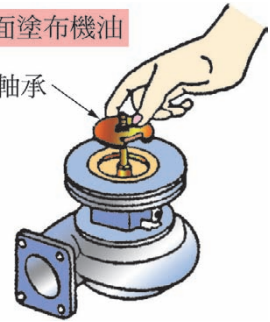
▲ 圖 8-16 安裝止推軸承
