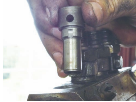
▲ 圖 7-35 取出柱塞筒
