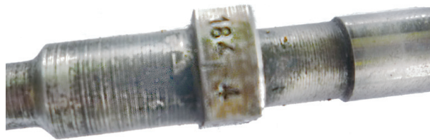
▲ 圖 7-43 柱塞凸緣記號
