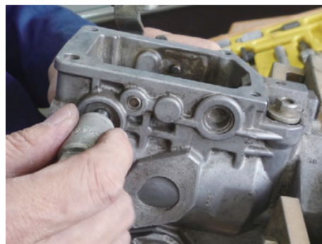
▲ 圖 7-75 拆卸調速器桿總成固定螺絲
