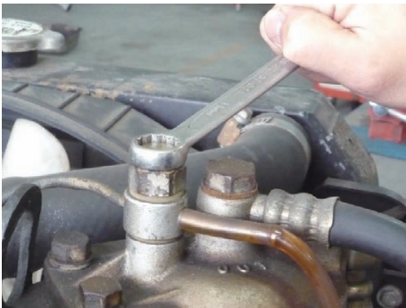
▲ 圖 4-2 濾清器上的放氣螺絲
