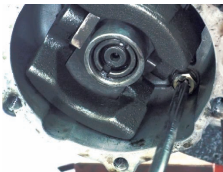
▲ 圖 7-25 拆下軸承蓋
