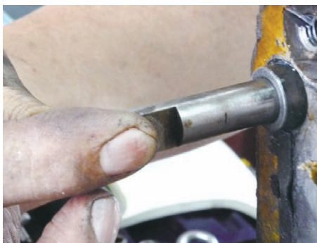
▲ 圖 7-38 安裝柱塞筒
