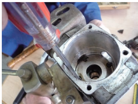
▲ 圖 7-85 鎖緊供油泵固定螺帽
