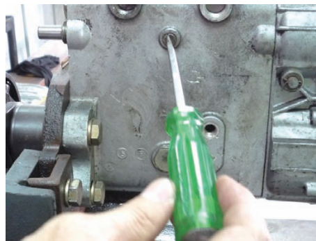
▲ 圖 6-12 裝鎖緊螺桿
