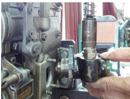
▲ 圖 7-2 取下供油泵
