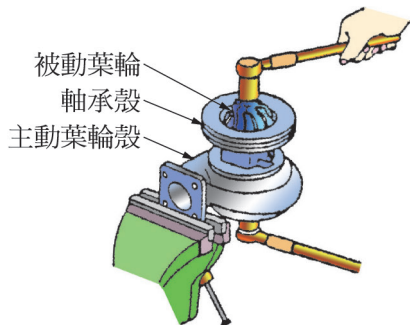
▲ 圖 8-8 拆除被動葉輪
