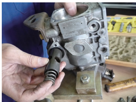
▲ 圖 7-78 取出自動正時器活塞
