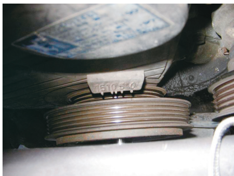
▲ 圖 7-11 第一缸上死點記號與前蓋板記號對正
